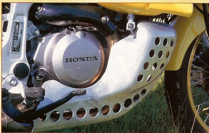
Loch an Loch: Der erleichterte Motorschutz verdeckt die Mende-Krümmen
