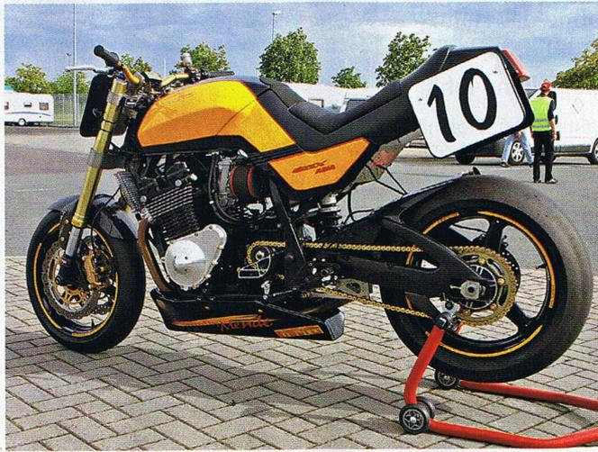
zylinder eine ordentliche Leistungskur: Hubraumerhöhung von 1135 auf 1300 Kubik, umgeschliffene Nockenwellen, optimierte Brennräume, modifizierte Ventile, überarbeitete Einlasskanäle – sozusagen das kleine Tuning-1x1. Dann mussten die originalen 36er-Mikuni-Vergaser dran glauben, die wurden durch 39er-Flachschieber von Keihin ersetzt. Der serienmäßige Papierluftfilter flog
