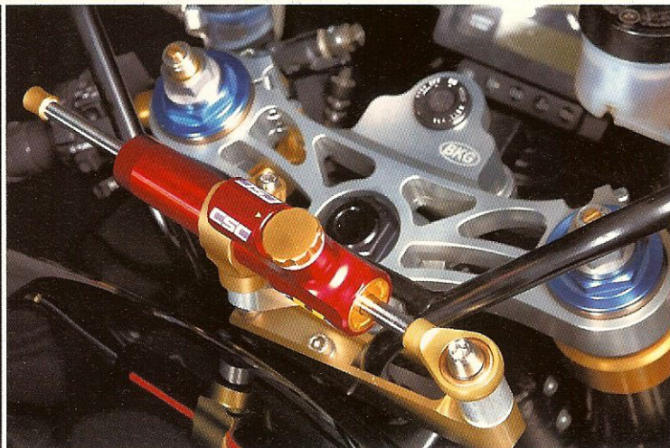
Fein ansprechender Hyperpro-Lenkungsdämpfer, filigran gefräste BKG-Gabelbrücke – edle und funktionale Details.
