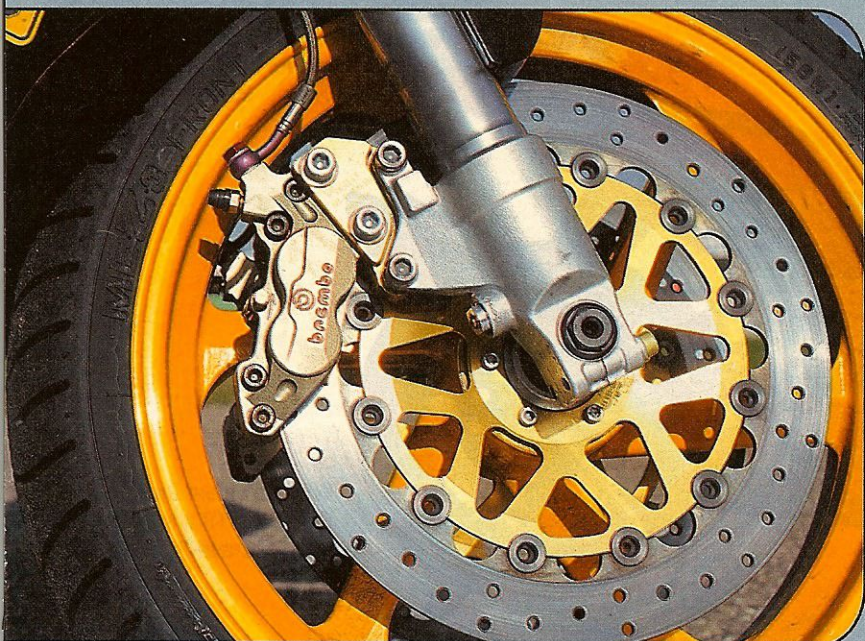
Brembo-Bremsanlage, leichte PVM-Felgen, CBR 900 RR-Gabel
