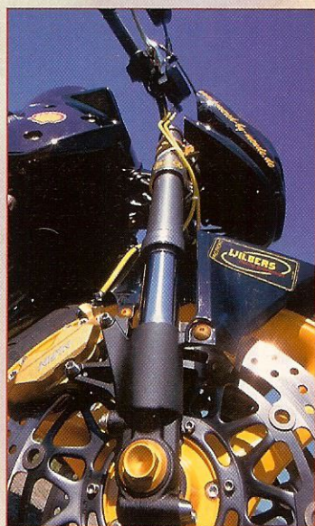
Umgedreht: Die Fireblade-Fork bringt erheblich mehr Stabilität
